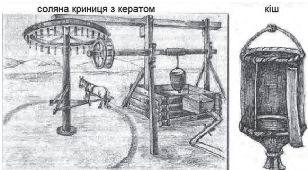
№ 2.70. Elementy robocze źródła solnego z kieratem, koszem, bukłakiem i rurami, XIX w.
